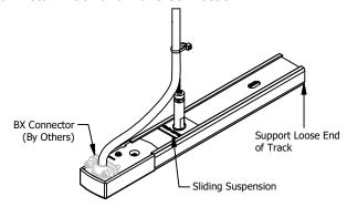
NOTE: GES TRACK SHOWN. FOR TEK/HTEK/XTS LOOSEN SCEW ON TRACK CLIP AND SLIDE TO DESIRED POSITION
