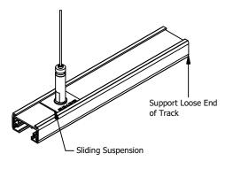
**NOTE:** GES TRACK SHOWN. FOR TEK/HTEK/XTS LOOSEN SCEW ON TRACK CLIP AND SLIDE TO DESIRED POSITION
