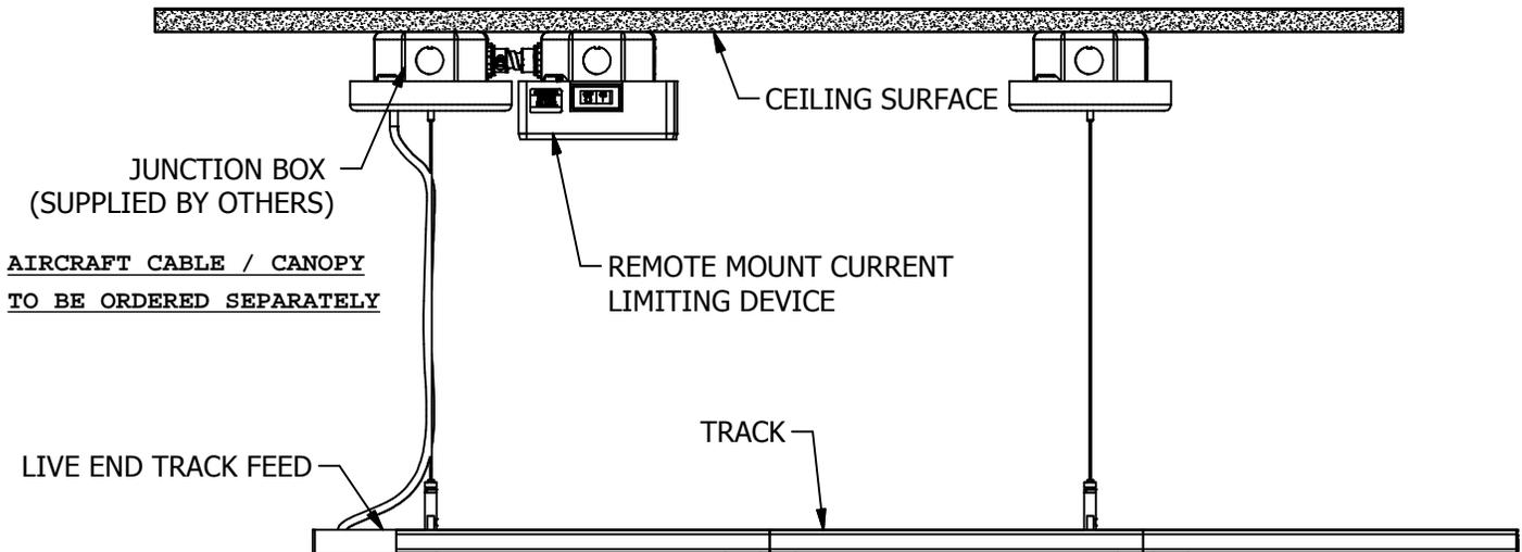
**GRID / DROP CEILING JUNCTION BOX MOUNTING**
