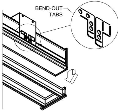
**B. ONCE OVER GRID ANCHOR FIXTURE BY BENDING THE TABS ONTO THE GRID TO LOCK IT.**
